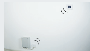
Funkübertragung mit 868 MHz für bis zu 35 m Reichweite
